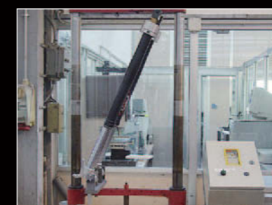
100 万サイクルに渡る耐久テスト。車種装着状態の角度でテストされる。
