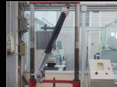
100万サイクルに渡る耐久テスト。 車輛装着状態の角度でテストされる。
